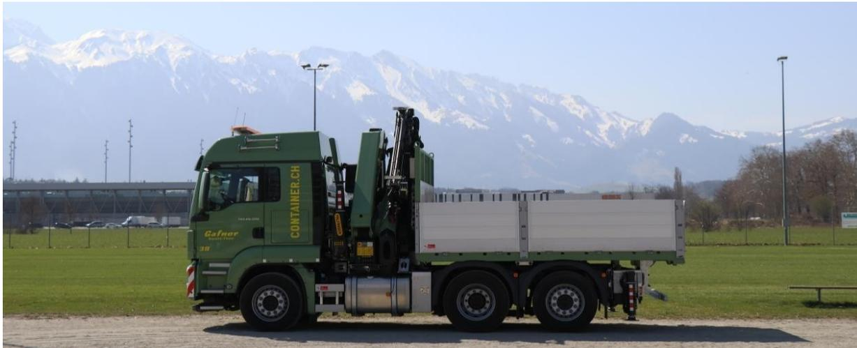
Abmessungen Ladefläche Länge: 4.00m Breite: 2.50m Ladekante Höhe: 1.30m
